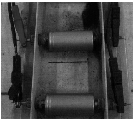
图 2-23 电池过放电试验参考图
