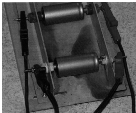
图 2-24 电池过充电试验参考图
