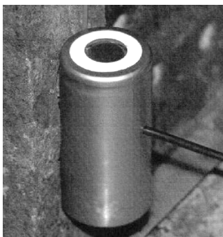
图 2-29 电池针刺试验参考图
