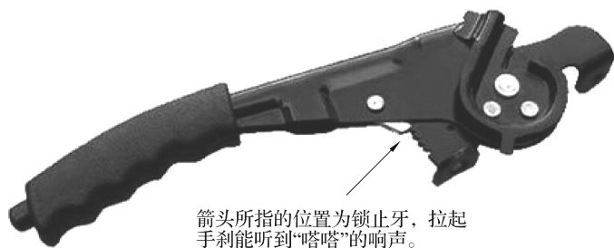
图 3-37 汽车驻车制动器
